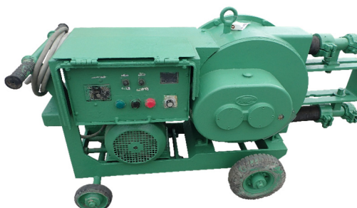
図 8.3 電動式グラウトポンプの一例
