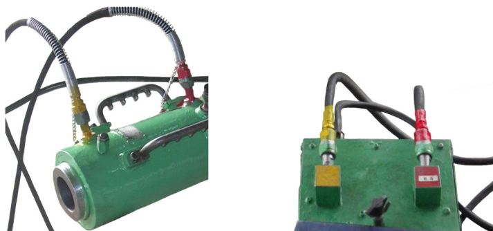
図 7.3 ホース接続の例（左：ジャッキとの接続，右：ポンプとの接続）
