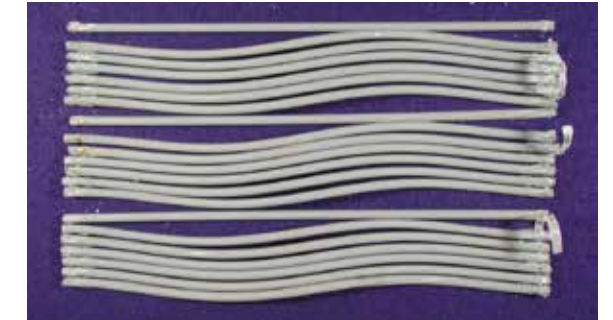
「Ducst」2,000時間試験後の内部状況
