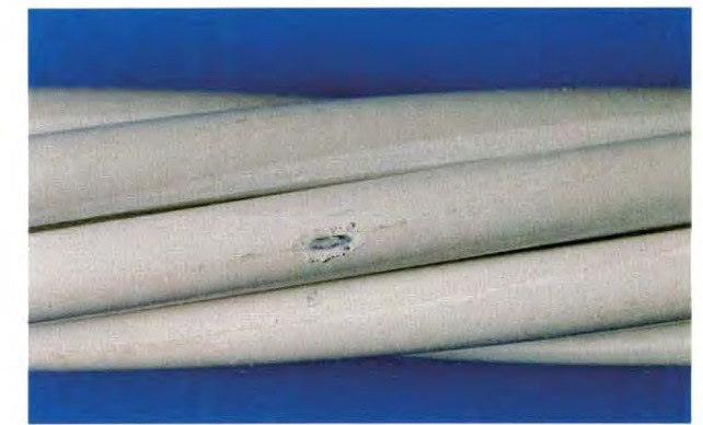
衝撃試験後のSC-S被膜状況
