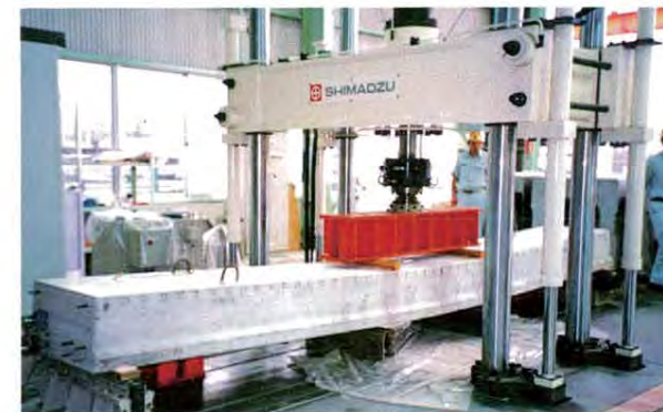
載荷試験破壊時の状況
