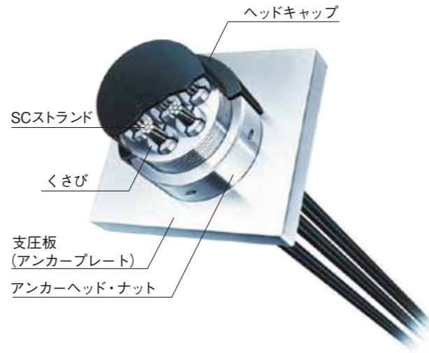
図-4 アンカー頭部
