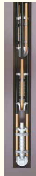
ストランドの構成 (KTB荷重分散型永久アンカーの場合)
