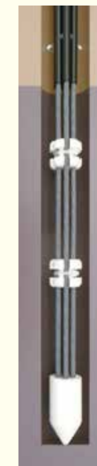
ストランドの構成 (KTB引張型SC永久アンカーの場合)
