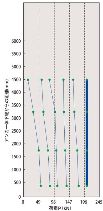
上図は、(財)砂防・地すべり技術センターの技術審査証明を得るために実施した現地実証試験の結果の一部です。耐荷体を4個使用し、地盤は緑色片岩の弱風化、普通、強風化したものの互層です。その結果は荷重の分散した状況が、発生した圧縮ひずみによって確認できました。なお、テンドン頭部の変位から換算した緊張力は各耐荷体にほぼ均等に分散していることがわかります。
