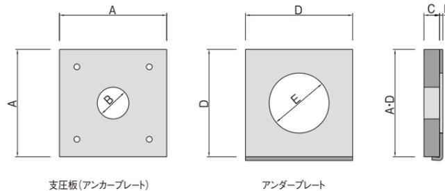
支圧板(アンカープレート)、アンダープレート形状寸法
