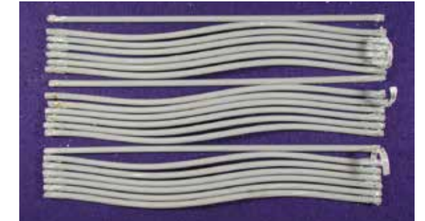
「Ducst」2,000時間試験後の内部状況
