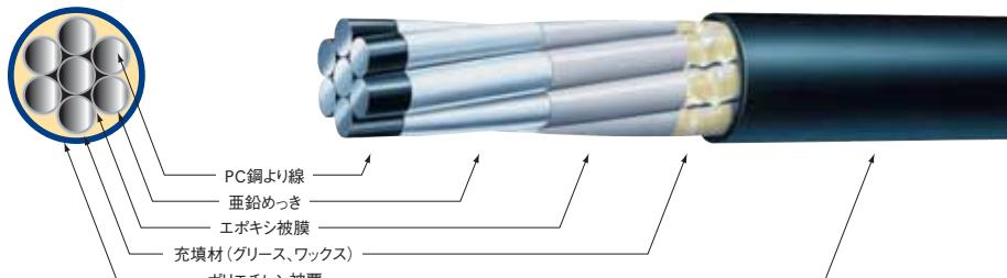
◎全素線を亜鉛めっき被膜(一次防錆層)とエポキシ樹脂被膜(二次防錆層)にて防錆した、世界初の全素線二重防錆PC銅より線。さらにアンボンド加工して完全防錆。
