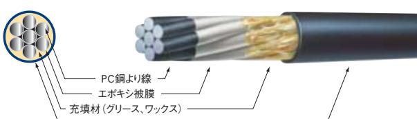
◎PC銅より線の芯線・側線の1本1本をエポキシ樹脂粉体塗装して防錆。さらにアンボンド加工して防食機能をよりグレードアップ。
