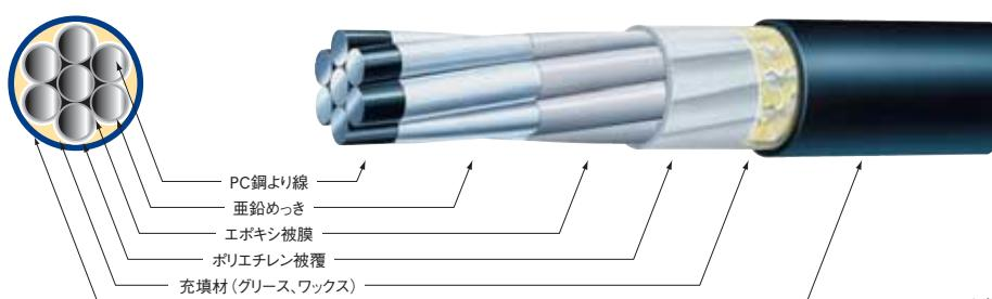
◎全素線を亜鉛めっき被膜(一次防錆層)とエポキシ樹脂被膜(二次防錆層)にて防錆した、世界初の全素線二重防錆PC銅より線。さらに二重にアンボンド加工して完全防錆。
