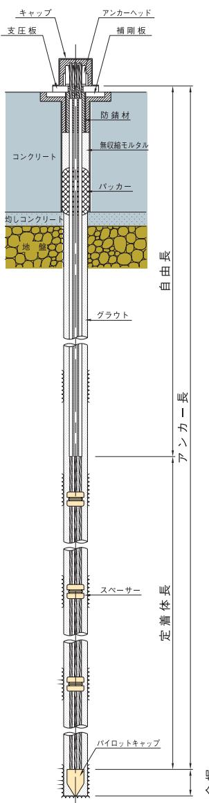
ストランドの構成(KTB荷重分散型永久アンカーの場合)
