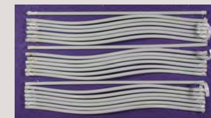
「Ducst」2,000時間試験後の内部状態
