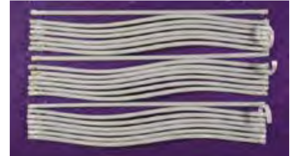
「Ducst」2,000時間試験後の内部状況
