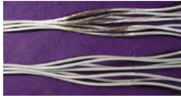
上:垂鉛めっきPC鋼より線(母材) 下:[Ducst]
