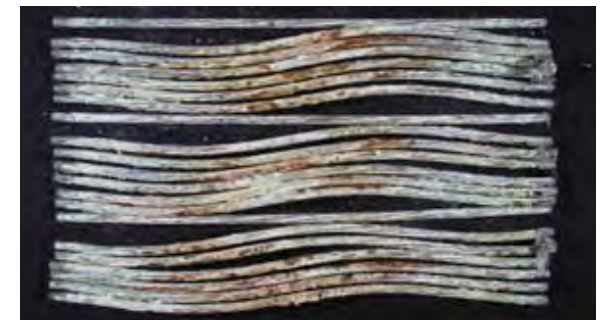
試験後内部状況 (「亜鉛めっきPC鋼より線」無緊張、人工傷有)
