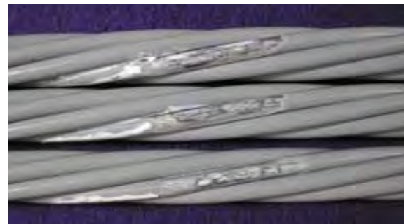
試験後塗膜下状況 (「Ducst」無緊張、人工傷有)
